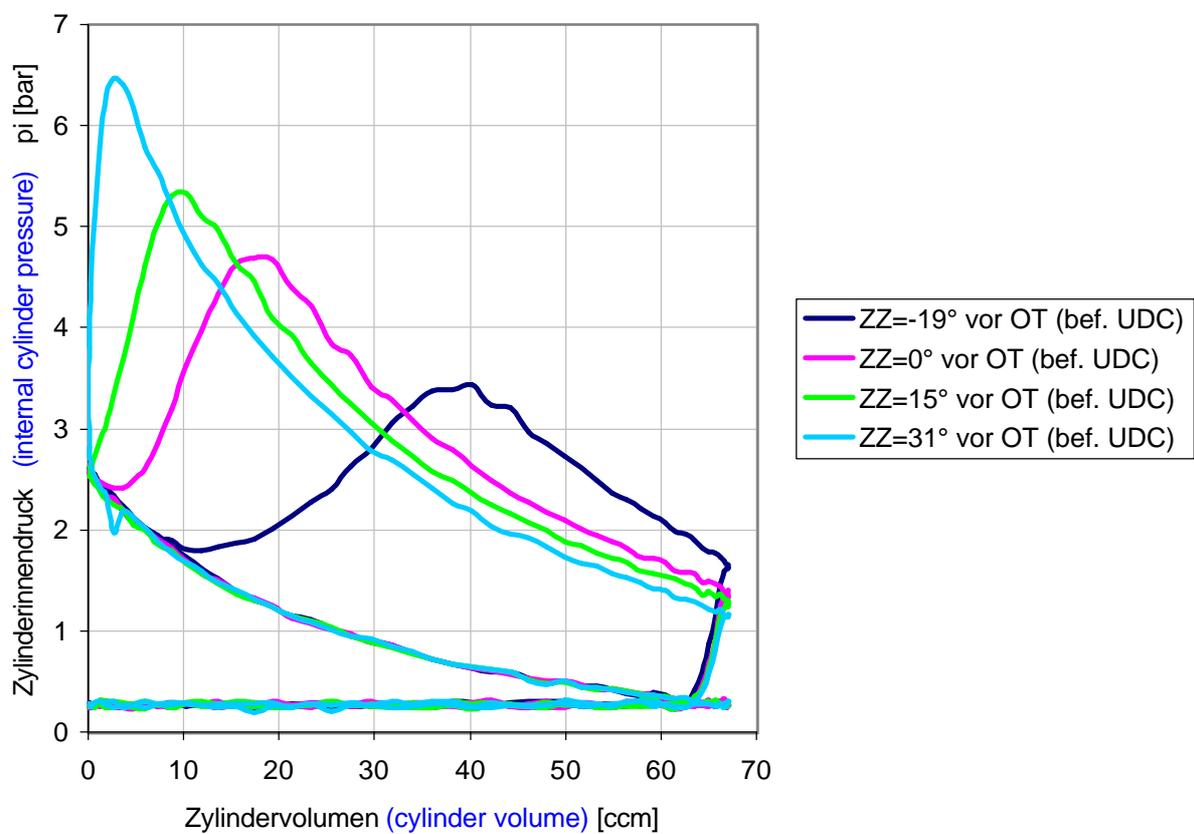
**Verluste in der Gaswechselschleife**
