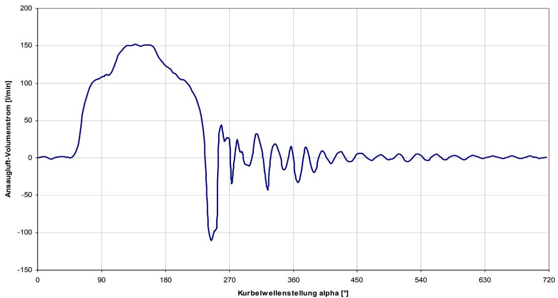
Sie zeigt den Ansaugluft-Volumenstrom, aufgetragen über dem Kurbelwinkel, hier ein Arbeitsspiel. Dabei ist zu sehen, dass im Bereich  $45^\circ$  bis ca.  $230^\circ$  Kurbelwinkel Luft angesaugt wird, danach aber noch Schwingungen im Ansaugrohr auftreten, die im weiteren Verlauf des Arbeitsspiels abklingen. Mit diesem Charakteristikum ist auch der Verlauf des Luftmengenstroms des Kaltstarts bzw. Warmlaufs zu erklären. Es treten Druckschwingungen im Ansaugrohr auf.
